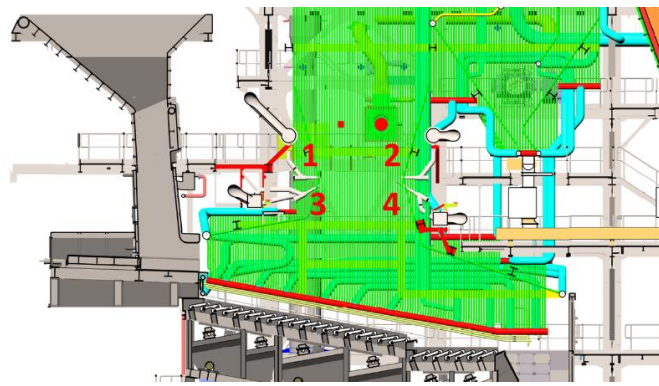
Rysunek 17. Miejsce wprowadzania powietrza wtórnego ad ruszt kotła. 1 - ściana przednia góra, 2 - ściana tylna góra, 3 - ściana przednia dół, 4 - ściana tylna dół.
