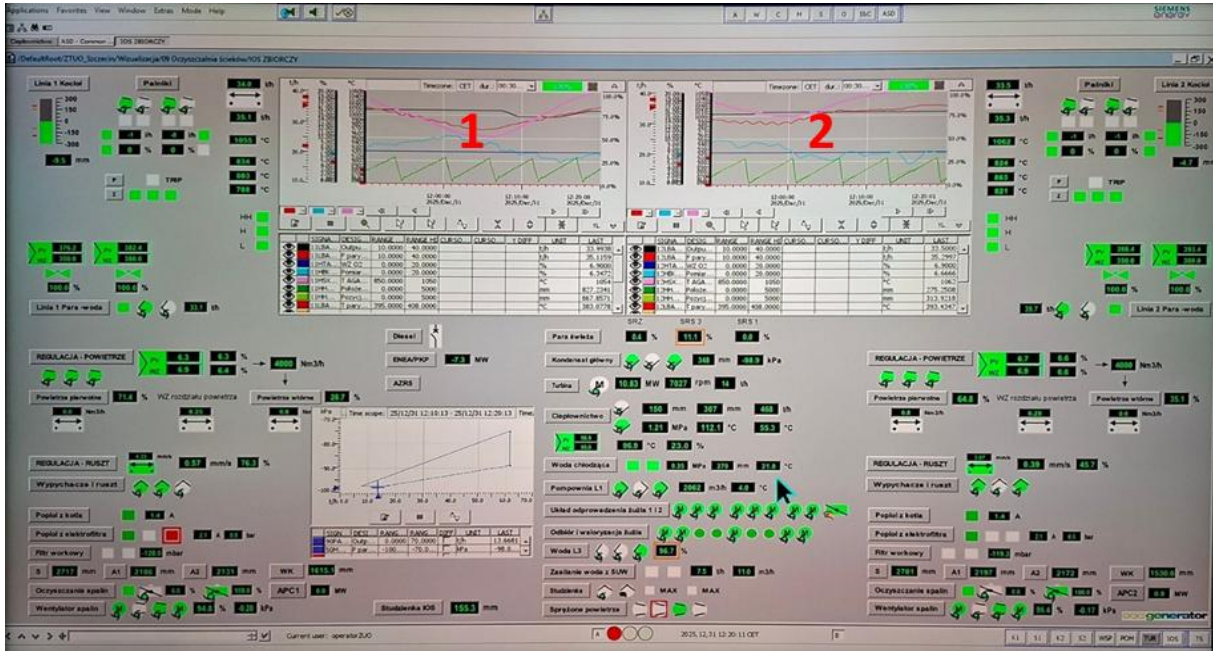
Rysunek 19. Synoptyka obrazująca sposób kontroli pracy kotłów oraz Zakładu. 1 - Wykres parametrów kotła linii 1 2 - wykres parametrów kotła 2.
