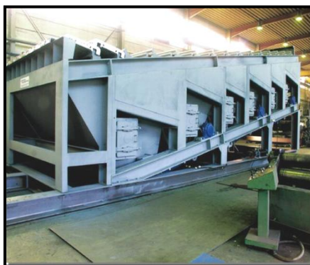
Rysunek 8. Ruszt podczas montażu wstępnego
